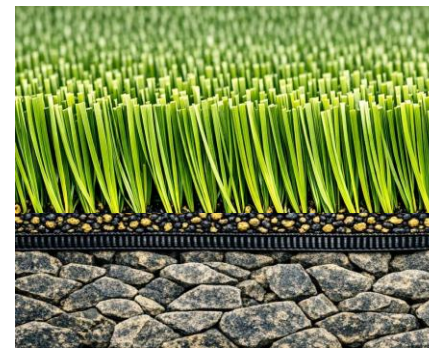
Stabilizirana: dubina ispunje je manja od 25% visine vlakana
